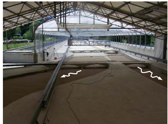
Versuchsmodell mit eingebautem Sohlmaterial Blick in Fließrichtung der Isar und entgegen
