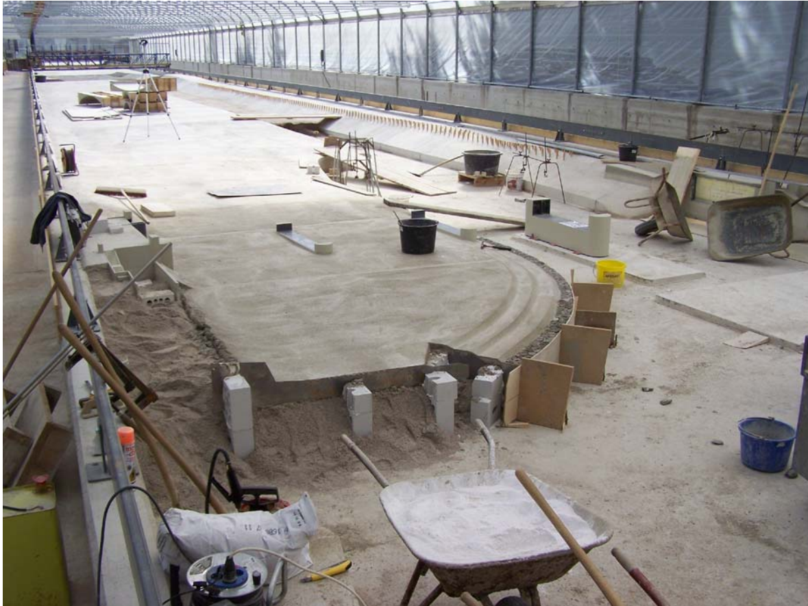
Umbauarbeiten am Modellversuch im Übergangsbereich zur kleinen Isar
