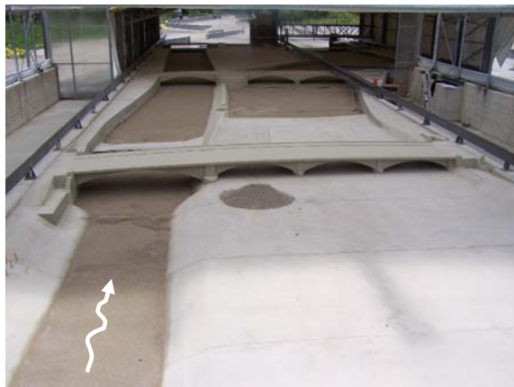
Versuchsmodell mit eingebautem Sohlmaterial Blick in Fließrichtung der Isar und entgegen
