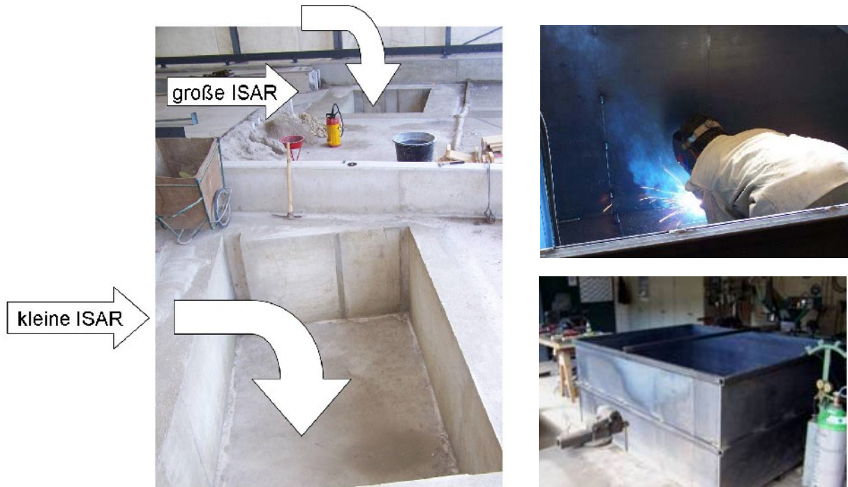
Sandfänge am Ende der Versuchsstrecke mit Wägeeinrichtung
