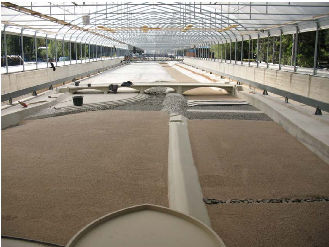
Modellversuch im Planzustand mit eingebauter Sohle
