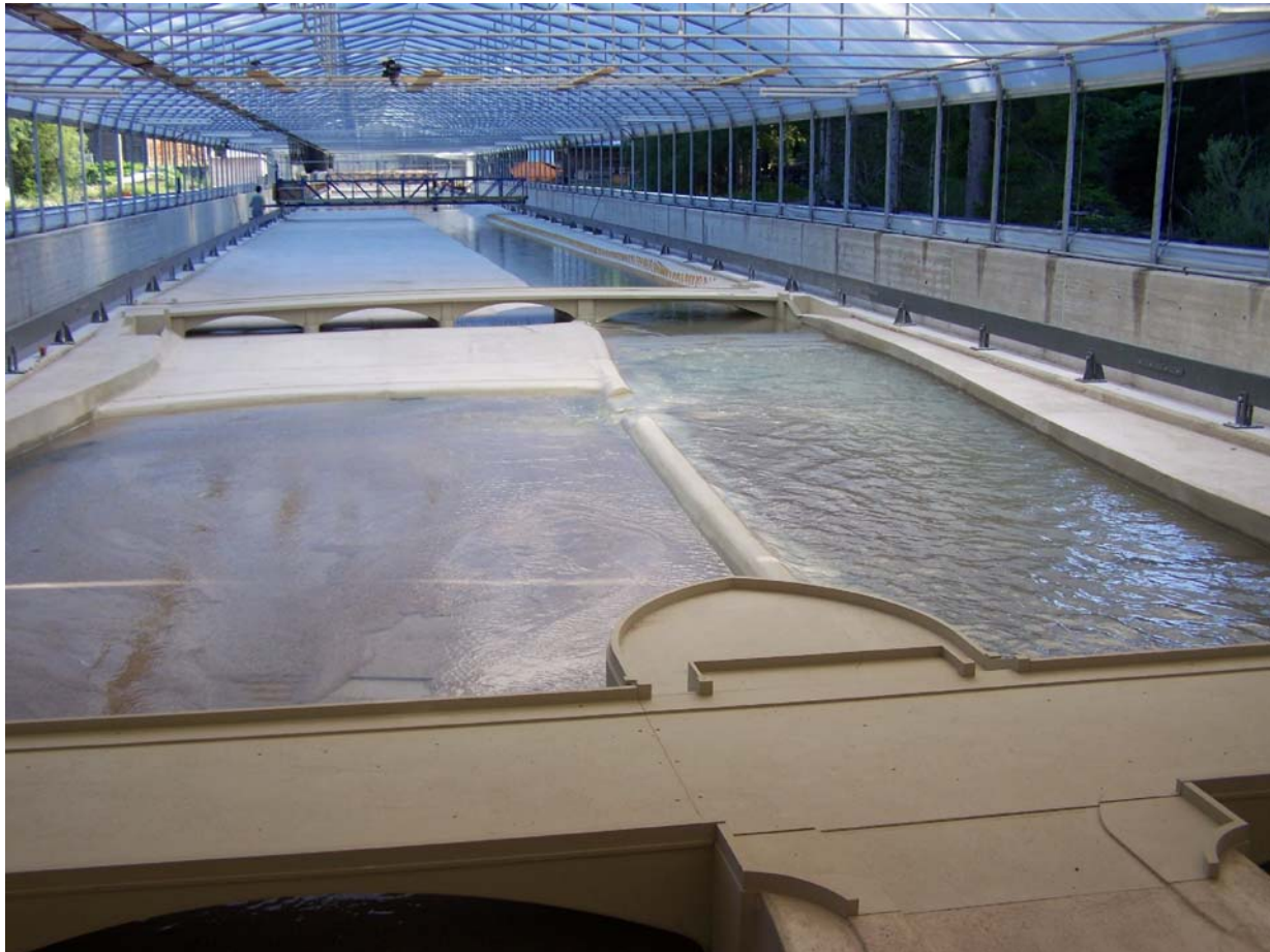
Blick von der Museumsinsel flussaufwärts Abflusssimulation eines 1-jährlichen Hochwassers (Ist-Zustand)
